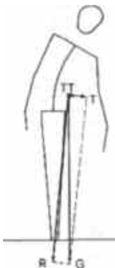
Sl. 58 Uspostavljanje kretanja iz normalnog uspravnog stava u stranu: TT - težište tela, G - sila teže, jednaka težini tela, R - radijalna komponenta sile teže, T tangencijalna komponenta sile teže
