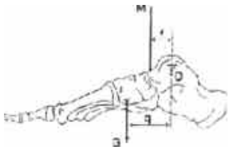
Sl. 31 Stopalo u položaju poluge brzine: O - fiksna tačka, M - sila mišića pregibača u gornjem skočnom zglobu, f - krak sile mišića, G - sila teže jednaka težini stopala, q - krak sile teže
